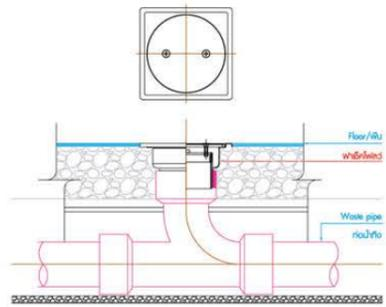
ภาพจำลองการติดตั้งฟาซึคโฟลว์ สำหรับใช้ในระบบท่อน้ำเสียที่ออกจากห้องน้ำ อ่างล้างหน้า หรือ ระบบน้ำเสียต่างๆ เมื่อเกิดการอุดตัน หากมีฟาซึคโฟลว์จะ สามารถตรวจหาจุดที่เกิดการอุดตันได้ง่ายและเร็วยิ่งขึ้น
