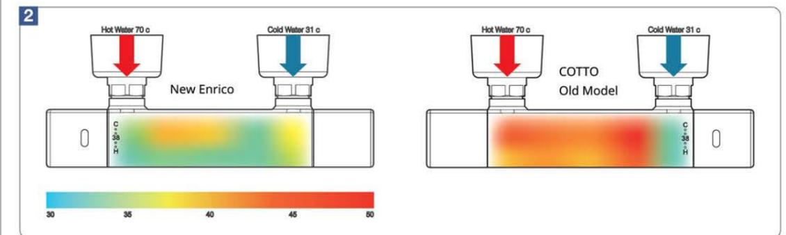
2 สีสันอุณหภูมิที่กระจายไปตามผิวสัมผัสของผลิตภัณฑ์ จากสีของ New Enrico จะสังเกตเห็นได้ว่าไม่ร้อนและมีอุณหภูมิคงที่ ในทั่วทุกบริเวณของผลิตภัณฑ์ปลอดภัยในการใช้งาน
